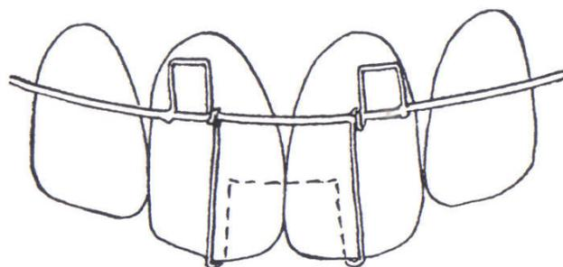
Abb. 156. Angeschweißte Verkürzungsschlinge mit Sicherungsschleifen.
