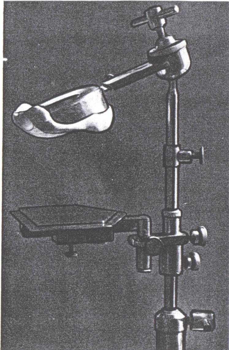
Abb. 198. KÜvettendeckel bis an den Nadelschlitten geschoben und dort fixiert.
